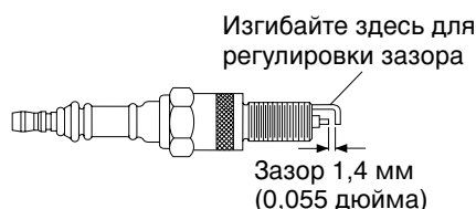
Рис. 12. Регулировка зазора свечи зажигания, нагреватель мощностью 10 кВт
